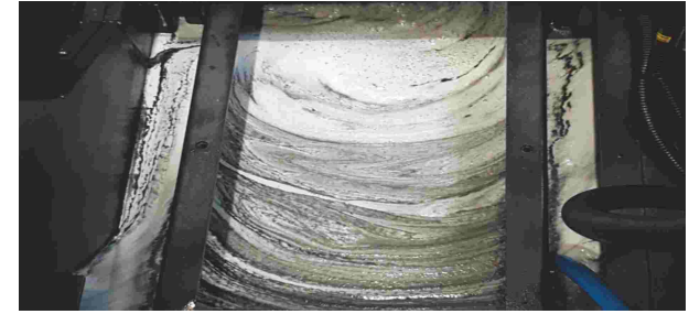
鑄件加工切削油箱（浮鐵粉和泡沫現象）
